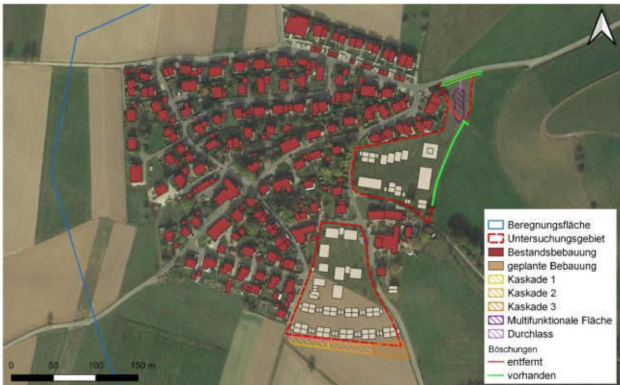
Abbildung 5: Maßnahmen zum Schutz vor Außengebietswasser bei Starkregen
