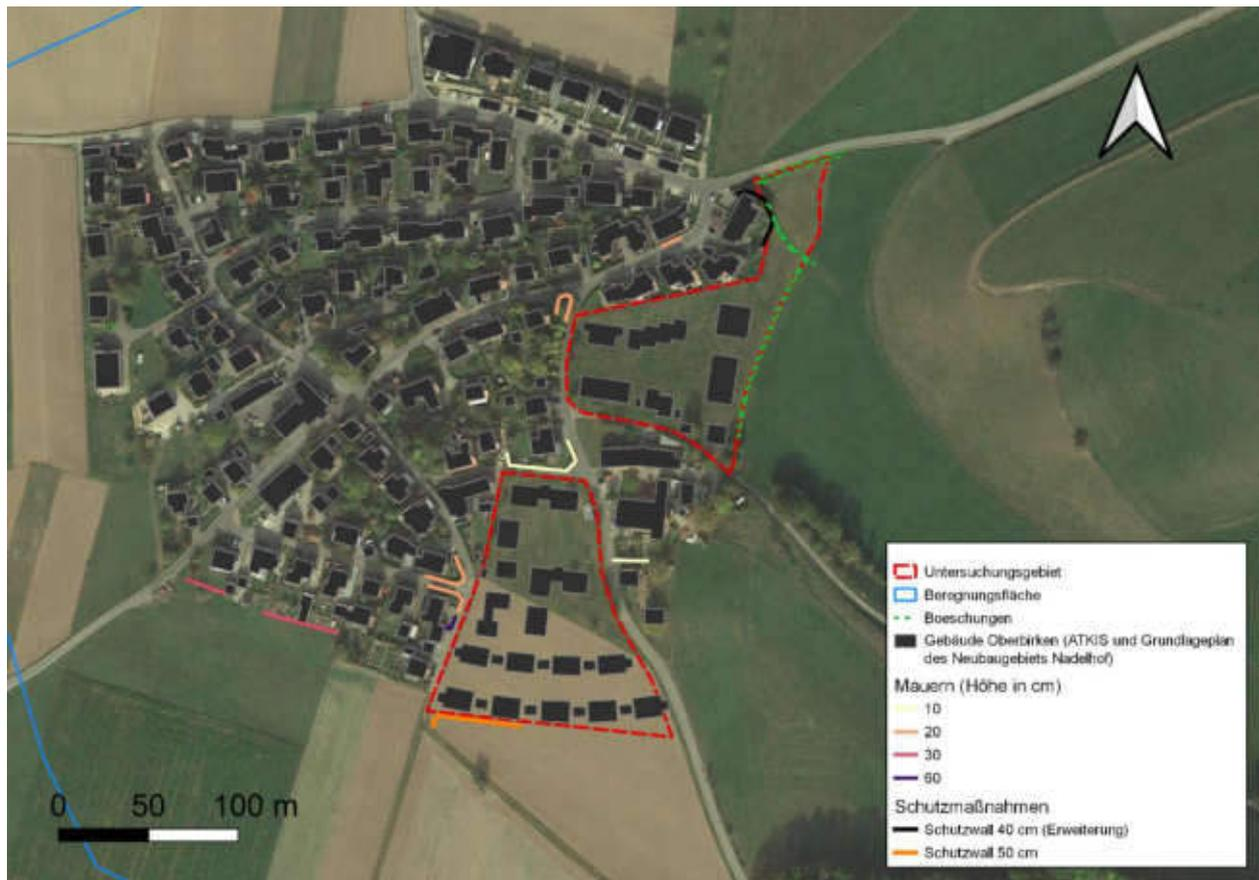
Abbildung 6: Abflussrelevante Strukturen
